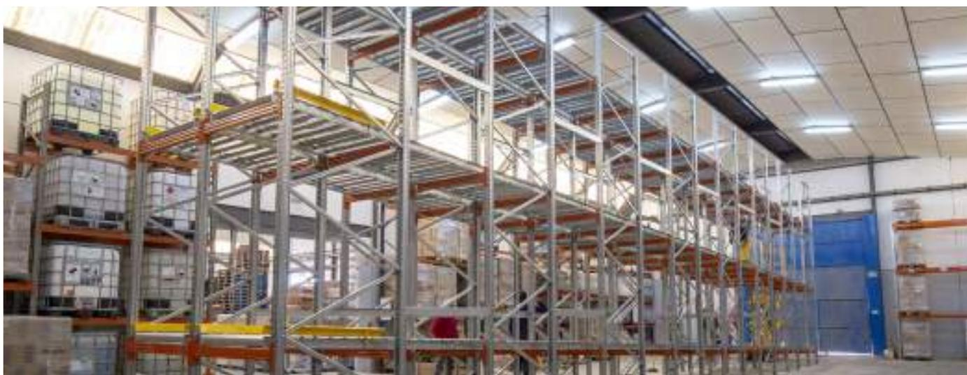
Este tipo de solución de almacenaje permite tanto la posibilidad de almacenaje tipo **FIFO** (*First In, First Out*) como **LIFO** (*Last In, First Out*). Sobre la estructura se colocan los carriles de rodillos con una leve inclinación para el deslizamiento de las mercancías en el interior de las estanterías.
