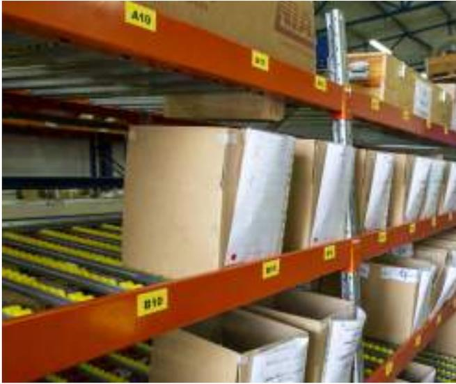
Al retirar el primer producto, el resto caen por gravedad y alcanzan la posición de este avanzando de manera automática, con lo que se asegura una óptima rotación del producto.
