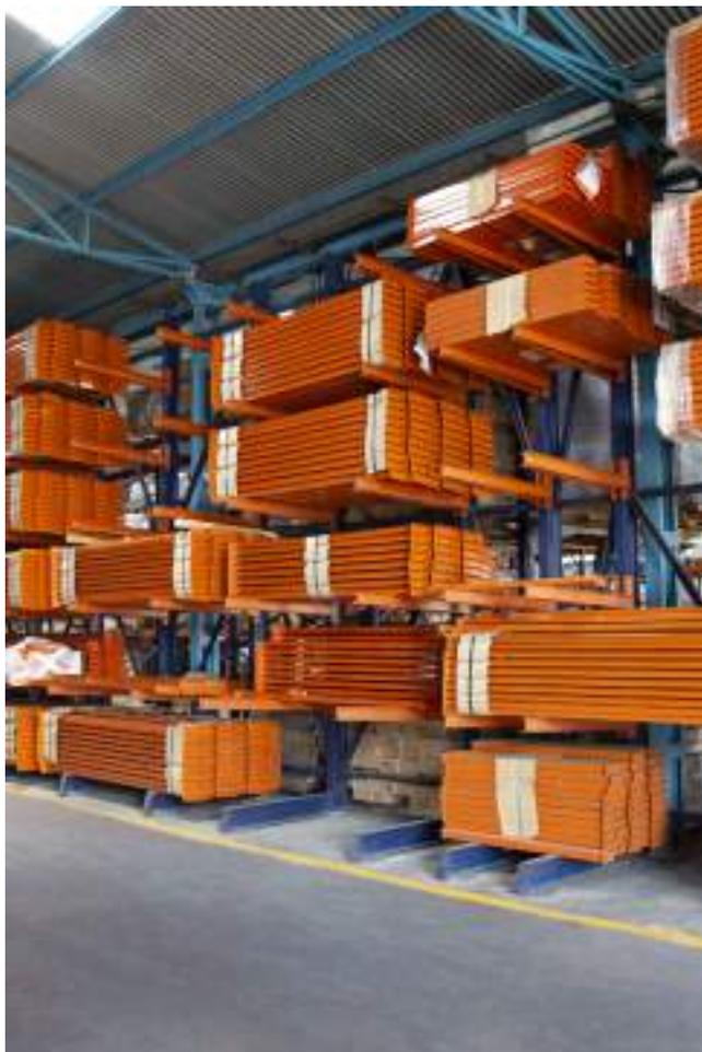
Las estanterías cantilever de **TECNY STAND** están diseñadas para soportar tanto cargas pesadas como ligeras pudiendo almacenar **hasta 2.500kg**. Se pueden combinar con altillos o entreplantas creando zonas de almacenaje bajo la estructura.
