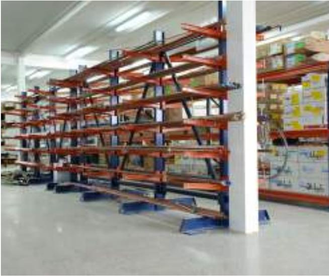
La estructura **cantilever** ofrece dos posibilidades: **Simple acceso** (mural) o **doble acceso** (góndola). Se adaptan a todo tipo de necesidades y se pueden complementar con módulos adicionales.
