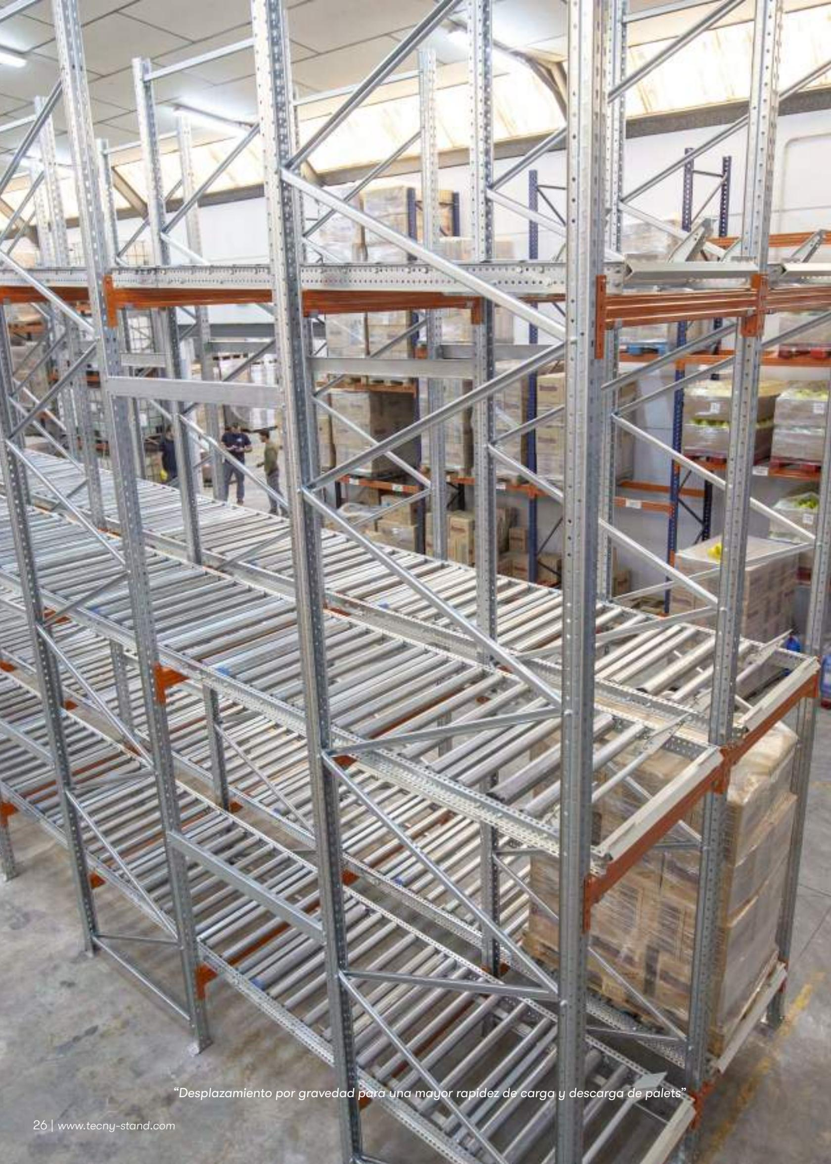
*“Desplazamiento por gravedad para una mayor rapidez de carga y descarga de palets”*
