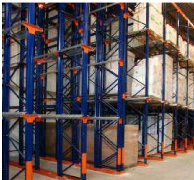
Las estanterías de **paletización compacta** se forman por calles de carga con carriles de apoyo sobre los que se deposita uniformemente la carga que va estibada sobre palets. Esta solución es apta para el almacenamiento de productos con la misma referencia.
