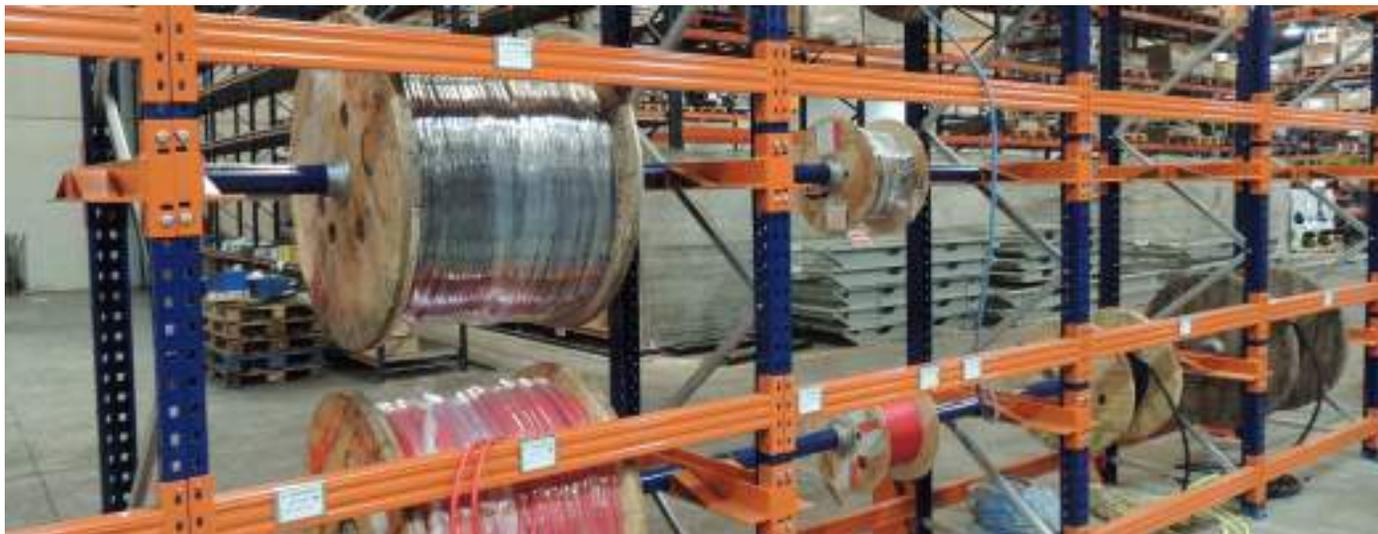
El montaje de este tipo de estantería metálica es sencillo. Está constituido por alineaciones de bastidores, largueros para cargas pesadas y un eje cilíndrico central para el soporte de las bobinas. Esta combinación nos permite ampliar o modificar el sistema si las circunstancias así lo requieren.
