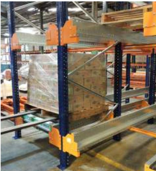
El sistema **TS Shuttle** es completamente independiente de cualquier otro dispositivo, por lo que no es necesaria realizar ninguna modificación en la carretilla para poder transportar la plataforma hasta el inicio de la calle que el operario desee. Con esto se consigue una mayor profundidad de almacenaje.
