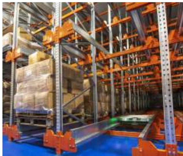
Este dispositivo semiautomático reconoce la posición correcta del palet dentro de la calle, lo que le permite posicionarlo para su traslado. La **opción multipalet** del sistema permite posicionar palets de diferentes medidas dentro del dispositivo.
