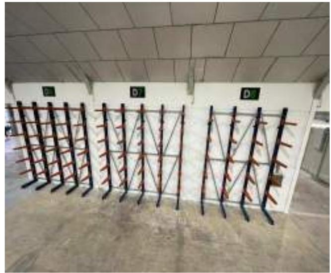
Los brazos de la estructura constituyen los niveles de carga. Son fácilmente **regulables en altura y longitud** para ajustarse a las dimensiones de la mercancía evitando posibles deformaciones, ofreciendo una gran seguridad a la carga.
