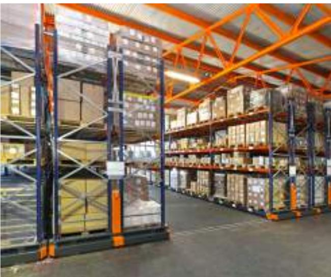
Instalación de fácil manejo en la que las estanterías se fijan a carros que se desplazan por rieles instalados en el suelo desplazándose lateralmente.
