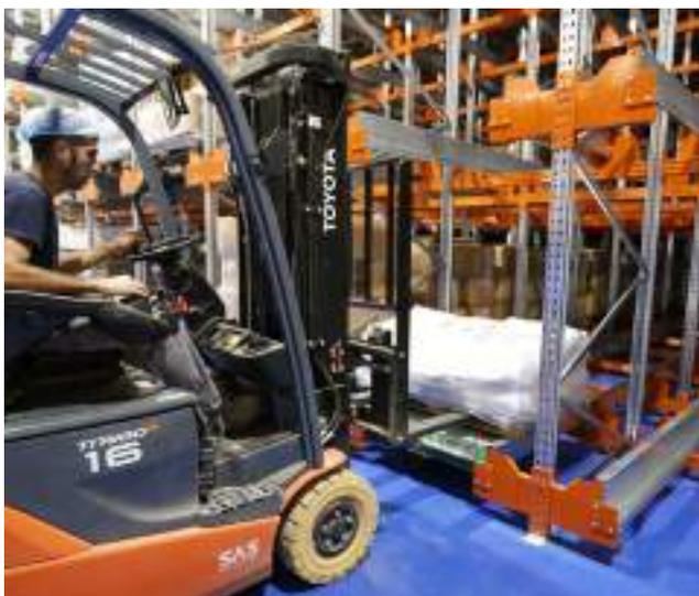
El **TS Shuttle** se coloca en la primera posición de la calle utilizando una carretilla elevadora. A continuación, se coloca el palet en la guía sobre el **TS Shuttle**. Para la extracción de palets, el orden es inverso.
