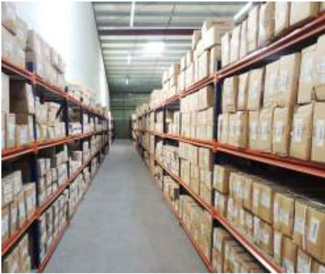
Un aspecto destacable de este sistema de almacenamiento es su polivalencia, ya que permite almacenar productos de diferentes pesos y características retirándolos de forma manual o mediante carretillas.
