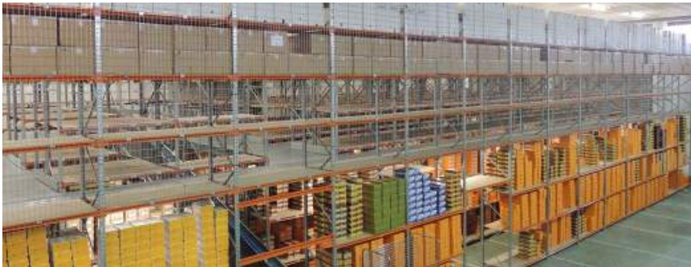
Esta solución de almacenaje permite construir diferentes niveles con pasillos elevados a los que los operarios acceden mediante escaleras. La mercancía se manipula de forma manual, mediante elevadores o cintas transportadoras. Se pueden añadir una gran variedad de accesorios, resultando una estructura muy adaptable a necesidades logísticas particulares.
