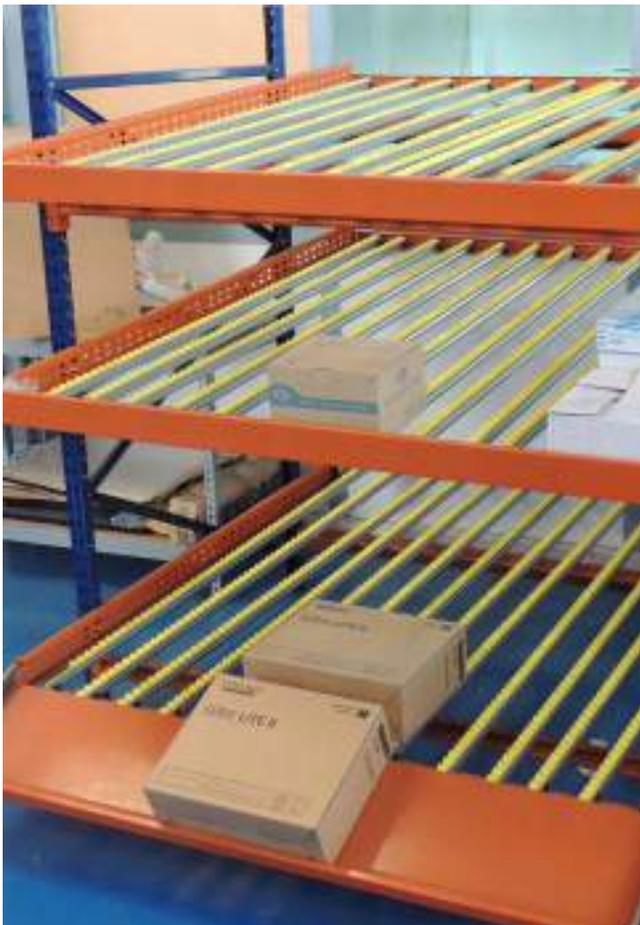
Se consigue una rápida extracción de mercancías y una óptima rotación del producto mediante el sistema **FIFO** (*First In, First Out*) en el que la primera unidad de carga en entrar es la primera en salir.
