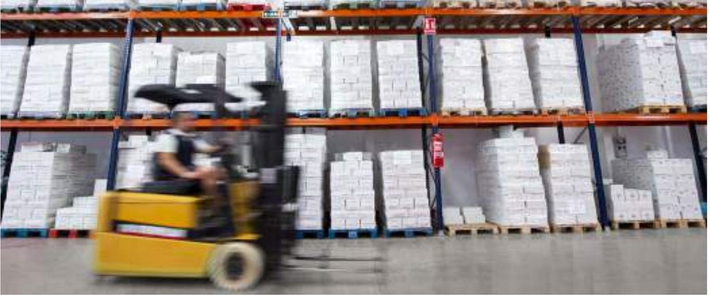
Es la solución más común y versátil empleada para el almacenaje de todo tipo de cargas paletizadas. El acceso a cada palet se realiza de manera directa mediante carretillas elevadoras. Permite además modificar fácilmente la disposición de los niveles de carga, gracias a la regulación de su altura.
