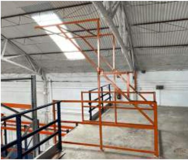
El sistema puede equiparse con **puertas de seguridad (marcado CE)** diseñadas para facilitar la carga y descarga de la mercancía.
