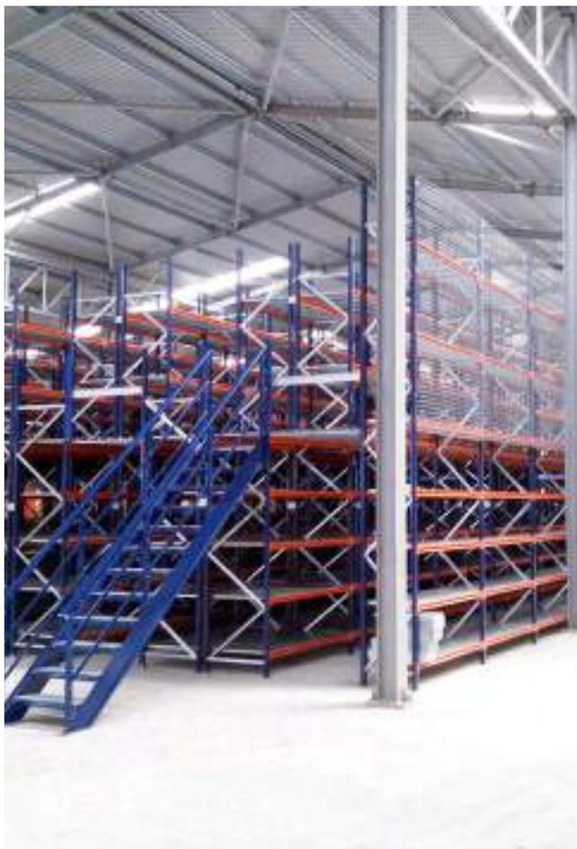
El sistema de **entreplantas** de **TECNY STAND** cuenta con escaleras y puertas de seguridad para el acceso a la estructura. Están dotados de protecciones anticaída como barandillas, rodapiés o mallas metálicas que garantizan la seguridad de los usuarios en las instalaciones.
