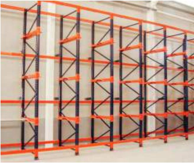
Una solución muy habitual es colocar la estructura adosada a la pared del local operando solamente por su parte frontal.
