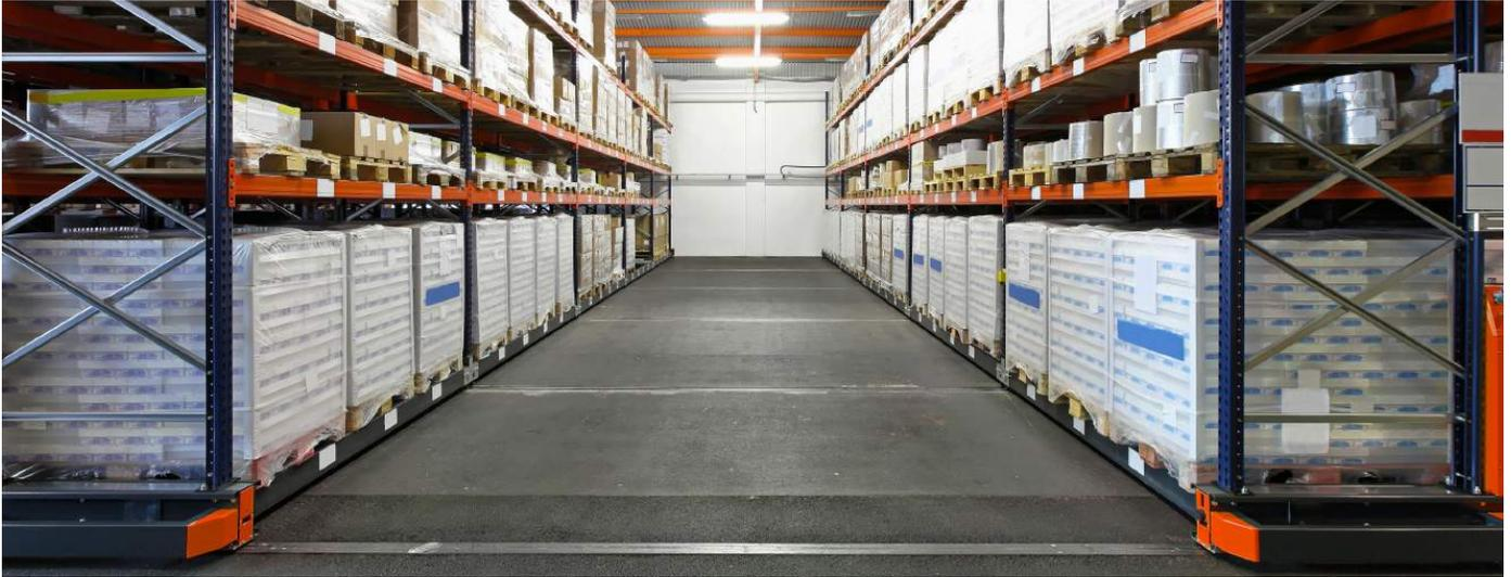
Las estanterías se fijan sobre una base móvil que se desplaza sobre rieles mediante un motor eléctrico. Este sistema está dotado de una gran capacidad que nos **permite almacenar un gran número de referencias**. Además, es compatible con otros sistemas de almacenaje.
