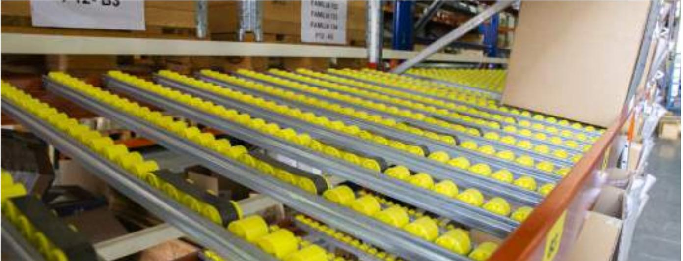
Este sistema de almacenaje manual está pensado para la reposición y recogida de mercancías por pasillos diferentes sin interferencias de paso, obteniendo así una disminución en el tiempo de preparación de pedidos.
