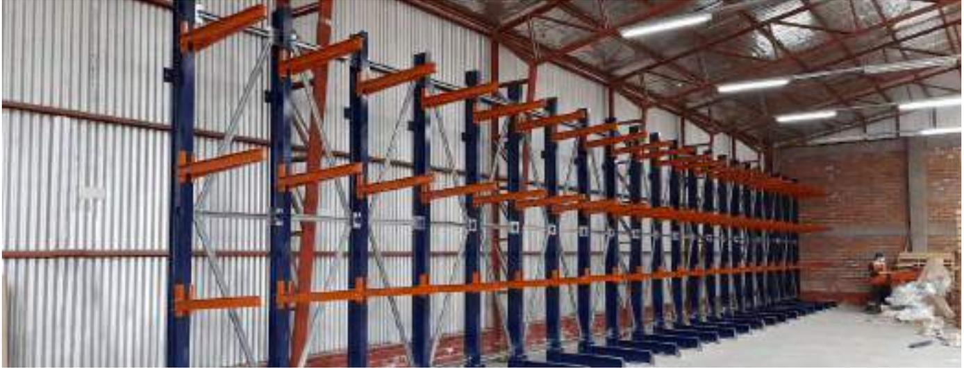
Las estructuras se componen de columnas centrales donde se fijan los brazos en voladizo para soportar las cargas. Pueden colocarse a diferentes alturas adaptándose a las dimensiones y distribución de la carga.
