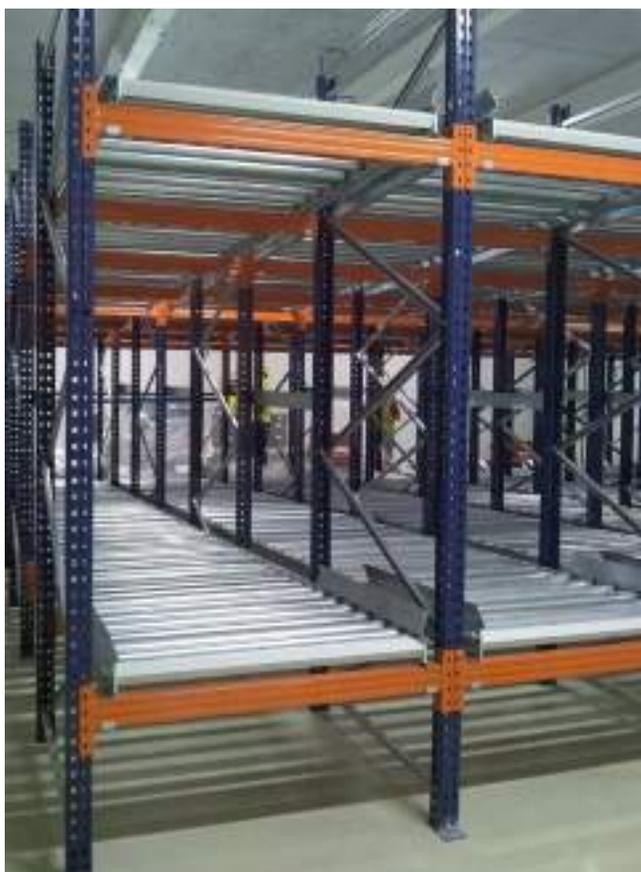
Sobre una estructura de estanterías de paletización se colocan los carriles de rodillos con una leve inclinación que permite el deslizamiento de las mercancías en el interior de la estantería.
