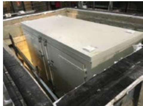
Prueba de resistencia al fuego del contenedor. Fotografía al inicio de la prueba.
