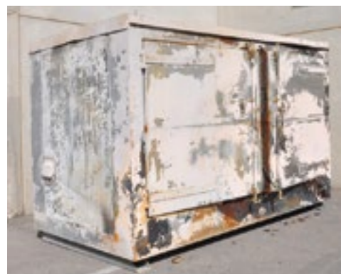
Estado del contenedor tras la prueba de resistencia al fuego.
