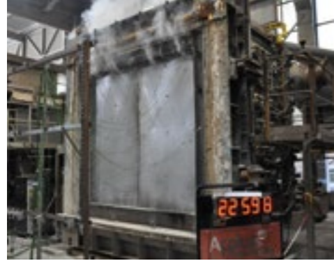
Prueba de resistencia al fuego de la puerta. Fotografía tomada durante la prueba.
